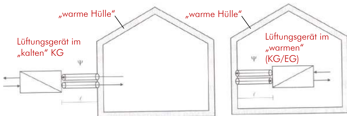
Abbildung 8: Lage des Lüftungsgerätes innerhalb oder außerhalb der „warmen Hülle“ [Ausgangsbasis für Abb.: FEI07]
